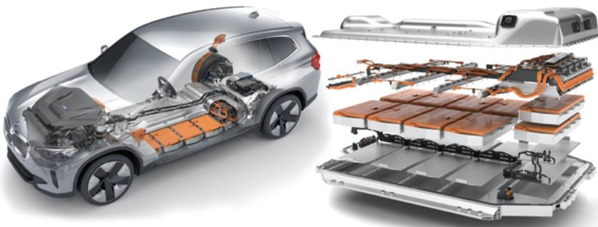
■ 그림 15. 마찰교반용접 기술이 적용된 전기 자동차의 배터리팩 부품의 사례
