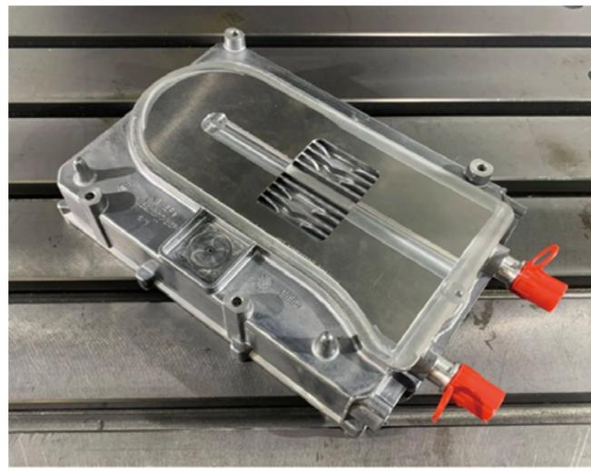
■ 그림 4. 마찰교반용접 기술로 제작된 히트싱크 부품의 사례(Stirweld社)
