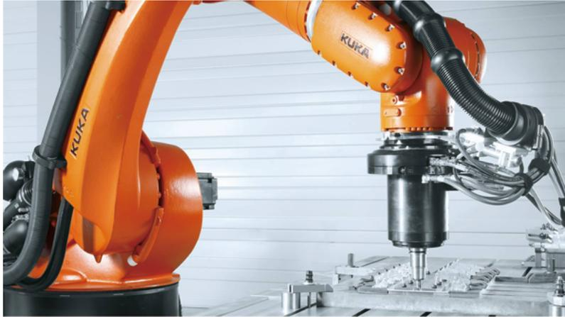
■ 그림 6. 수직 다관절 로봇 머니플레이이터에 직결식 스피들로 구성된 마찰교반용접 장비의 사례(Kuka robotics社)
